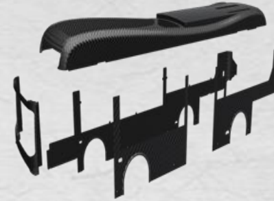
Composite Material Carbon Fiber (전기버스 탄소섬유 차체)
